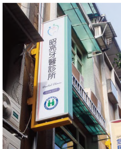
6.金屬造型框+壓克力三面燈箱
