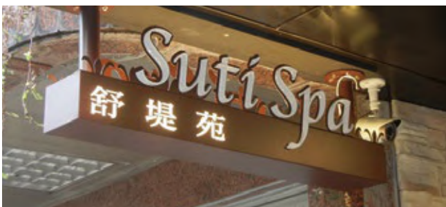
9.金屬雷射鏤空燈箱+壓克力字
